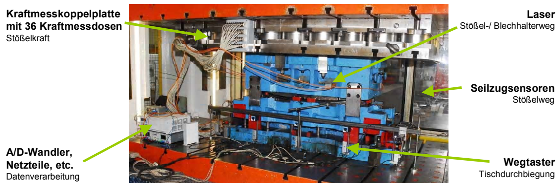
Bild 2: Messaufbau zur Ermittlung der notwendigen Kraftbedarfe mittels Kraftmesskoppelplatte sowie der Tischdurchbiegung und Verfahrswege
